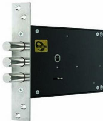
Универсальный замок, подходящий для установки как на правые, так и на левые двери. Снабжен запорным механизмом врезного типа с тремя стальными ригелями, что обеспечивает высокое сопротивление при попытке отжима, а также моторным приводом с стопором в крайних положениях.
