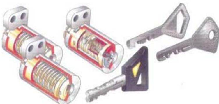
Дисковые ЦМС — запатентованное изобретение фирмы «ABLOY» (Финляндия). Роль кодовых элементов в них выполняют специальные вращаемые ключом диски (шайбы) с кодовой прорезью.
