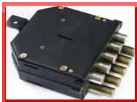
Ключ вводится в скважину врезного замка. После полуоборота ключа в замке, он может быть введен глубже – в накладной замок. После выполнения полного цикла запирания (отпирания) в накладном замке (2 полных оборота ключа), ключ снова выдвигается (до упора) во врезной замок и после завершения цикла запирания (отпирания)- оставшиеся 3 полуоборота, извлекается из блока.
