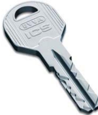
Находящиеся внутри цилиндра подпружиненные считающие элементы-слайдеры (по 5 с каждой стороны ключа) распознают код и выстраивают в единственное правильное положение, при котором становится возможным смещение запирающих планок — двух продольных элементов, которые блокируют вращение сердечника цилиндра. В отличие от «классического» устройства цилиндра, в «Evva ICS» в основной кодовой части нет раздельных цилиндрических элементов.
