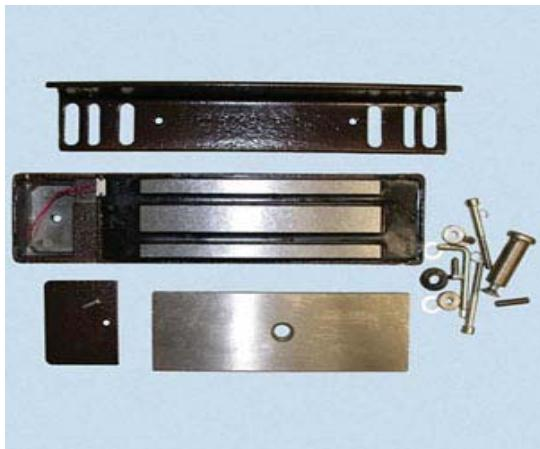
Этот замок выполнен из тонкой (1 мм) штампованной стали с последующей сваркой. При 13,7 В электронные весы показали 390 кг усилия удержания, что можно считать соответствующим заявленным параметрам. Остаточная намагниченность - 1,5 кг. Покрытие рабочей части электромагнита отсутствует, зато якорь оцинкован (с оксидированием). Крышка отсека электроники крепится двумя винтами M 2,5x10, что при монтаже может вызывать затруднения.
