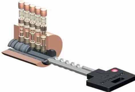
Замки и цилинды Classic высокой степени секретности компании «Mul-t-Lock» оснащены уникальным механизмом телескопических штифтов (пинов). Штифты располагаются «пин в пине». Система запатентована. Для того чтобы сердечник в корпусе совершил вращение, необходимо чтобы общие торцы пар внешних и внутренних штифтов совпали на поверхности контакта сердечника и цилиндрического отверстия в корпусе.
