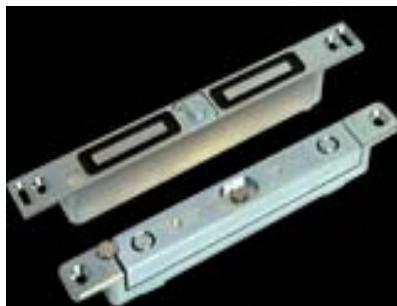
Электромагнитные сдвиговые замки являются наиболее устойчивыми к взлому среди всех типов электромагнитных замков. В первую очередь это достигается врезным (скрытым) способом монтажа на двери. Сдвиговые врезные электромагнитные замки применяются на маятниковых и распашных дверях, открывающихся в любую сторону. Не занимают дверной проем и имеют пониженное энергопотребление. Модельный ряд с усилием удержания от 250 кгс до 500 кгс.
