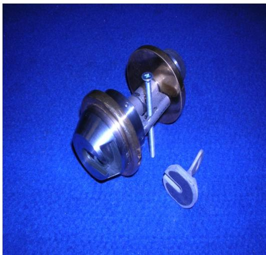
ЦМС «МОСКОД» является механическим устройством, не содержит электроники и оптики, не требует электропитания. Особенность этих цилиндров - отсутствие непосредственного механического контакта блокирующих элементов с ключом, что в принципе устраниет возможность их вскрытия отмычками, а также электронными или механическими приспособлениями.
