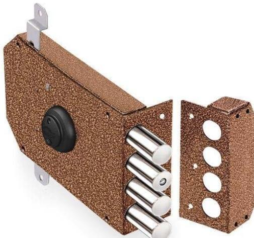
Сувальды имеют ложные пазы на шифрующих выступах, стойка хвостовика засова имеет П-образную форму — это затрудняет вскрытие замка манипуляционным методом. Защита от высверливания — термообработанная стойка хвостовика засова и накладная защитная пластина толщиной 2 мм (твёрдость по Роквеллу 58 HRC), закрывающая зону стойки. Имеется защита от открытия «свертышем» - ослабление зубцов гребенки засова.
