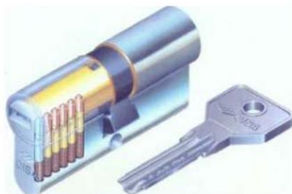
Профиль ключа имеет диагональную симметрию с дублированием нарезки секрета с обеих его сторон. Такой ключ называют «реверсивным». Это позволяет вводить ключ в скважину без четкой ориентации по стороне.
