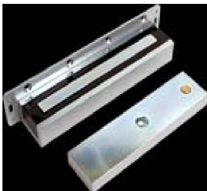
Влагозащищенные электромагнитные замки серии «FB» выпускаются в климатическом исполнении У2 и рекомендуются для эксплуатации как в помещениях с повышенной влажностью, так и на открытом воздухе без прямого попадания осадков и конденсации влаги. Замки серии «FB» также применяются для блокирования дверей в морозильных и холодильных камерах и сохраняют работоспособность при температурном режиме от -50С до +50С.
