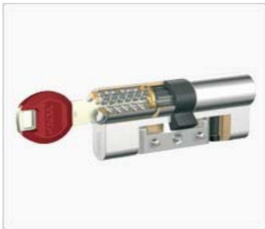
Высокий уровень секретности цилиндра «KABA PENTA» достигается конструкцией цилиндра с пятью рядами штифтов, расположенных радиально в пяти плоскостях с одновременным использованием 22 пар
