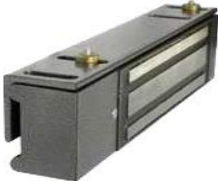
Данный замок выполнен из алюминиевого сплава литьем. На вид это добротно и аккуратно сделанное изделие. В качестве антикоррозийного покрытия используется лак - как на рабочей поверхности замка, так и на якоре. Достаточно просторный отсек электроники позволяет установить и обслуживать практически любой контроллер управления из представленных для таких целей на рынке систем безопасности. Цвета исполнения: серый и коричневый. Замок поставляется с уголком.
